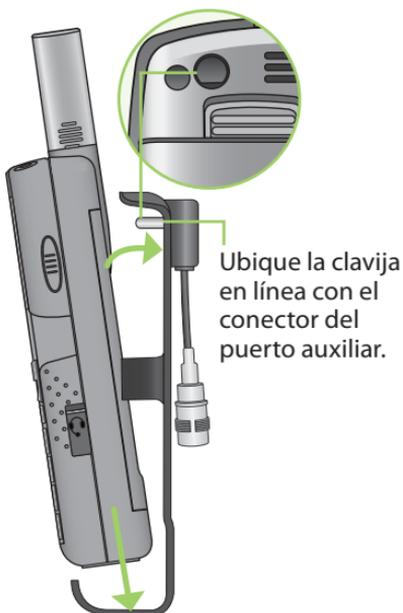
2. Gire hasta que la parte posterior del teléfono llegue al adaptador.
