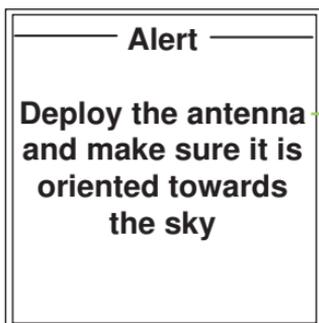
**Nota:** El teléfono satelital 9555 emite este mensaje cuando la antena no está completamente extendida.
